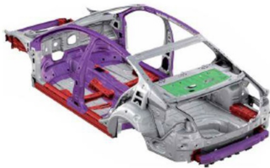
Abbildung 1: Werkstoffe in der Karosseriestruktur der Passat Limousine [4]
